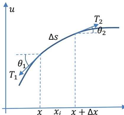
Debido a (H<sub>3</sub>) las tensiones  $T_1$  y  $T_2$  son tangentes a la curva y conforman con el eje horizontal los ángulos  $\theta_1$  y  $\theta_2$  diagramados en la Figura.
