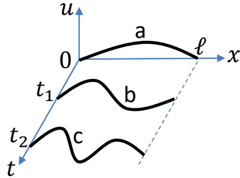
El proceso de oscilación se describe dando la forma que adopta la cuerda en distintos tiempos  $t = 0, t = t_1, t = t_2, \dots$  que representan fotografías “a”, “b”, “c”, ... de la cuerda. Por ejemplo  $u(x, t_1)$  representa la foto “b”.
